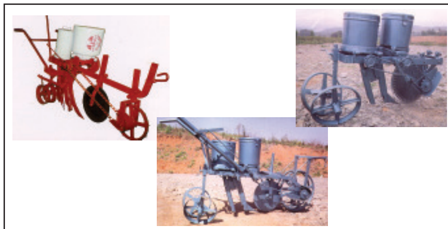
Figura 71. Implementos utilizados no sulcamento para transplante direto da cebola
